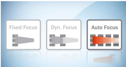
凭借自动聚焦功能，实现了巨大的景深。由于集成了自动聚焦功能，只需一台设备即可应对各种代码尺寸和不断变化的读取距离，以便覆盖较大的工作范围。此外，还省去了诸如光电传感器等触发焦点切换的传感器。
