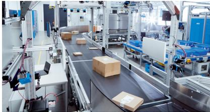
通过联网和追踪提高效率。CLV69x 设备可以作为追踪系统彼此全方位联网。凭借其集成的追踪功能，固定式条形码扫描器可实现不同高度物体的高吞吐量，无论输送设备上的代码方向如何（360° 读取）。
