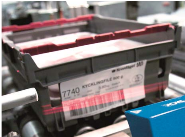
图 4: 即使在光线不佳的情况下, 摆镜型条码阅读器也能读取指定范围内的条形码。
