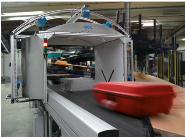
图 1: 无线射频识别与激光扫描仪技术的组合用于例如机场行李分拣(左侧)和自助行李托运(右侧)的行李识别系统。
