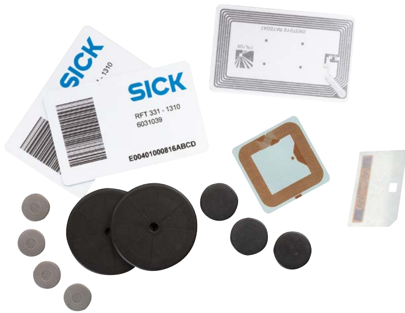
图 2: 形状各异的无源 HF 和 UHF RFID 电子标签减轻物体加装作业并可充当身份证。UHF 和 HF 标签的天线和芯片设计由于能量和数据传输运行方式不同而有着显著区别(最右侧标签: UHF, 其余: HF)。
