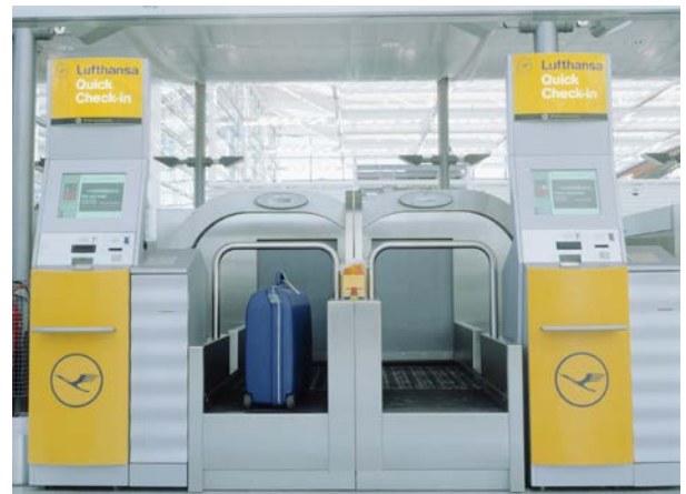
图 1: 无线射频识别与激光扫描仪技术的组合用于例如机场行李分拣(左侧)和自助行李托运(右侧)的行李识别系统。
