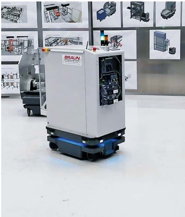
BS-Trayshuttle能自主地从一台托盘运输机上拾取小型运载工具 (KLT) 或托盘, 并将它们放入另一台托盘运输机。
