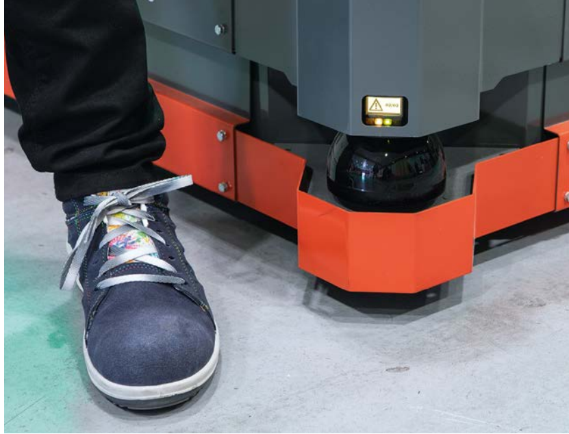
microScan3安全激光扫描仪确保了自主式移动机器人的良好运行, 并且由于采用了创新的safeHDDM®扫描技术, 具有优异的抗污、抗尘和耐光能力。
