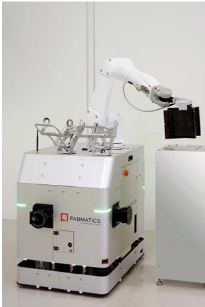
HERO®FAB将成熟、洁净且安全的机器人系统与创新的自动导引系统相结合。
