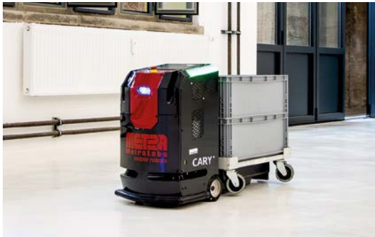
CARY是一种小型自动堆垛车,用于运输载货台车。
