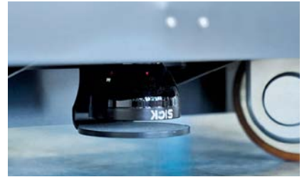
车辆底部有三个microScan3安全激光扫描仪用于定位和导航。
