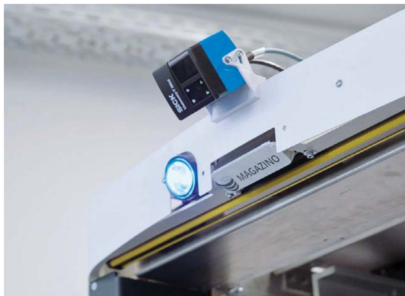
Visionary-T Mini 3D视觉传感器从上方检查行进路径，以支持导航并识别不在安全激光扫描仪高度的障碍物。
