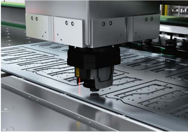
插图 11: 利用位移传感器 OD Max 在切割头上进行距离控制
