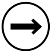
图 4: 根据 EN 60947-5-1 附件 K, 强制打开触点的标识
