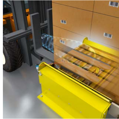
借助叉车上的无线射频识别传感器全程追踪物流过程
