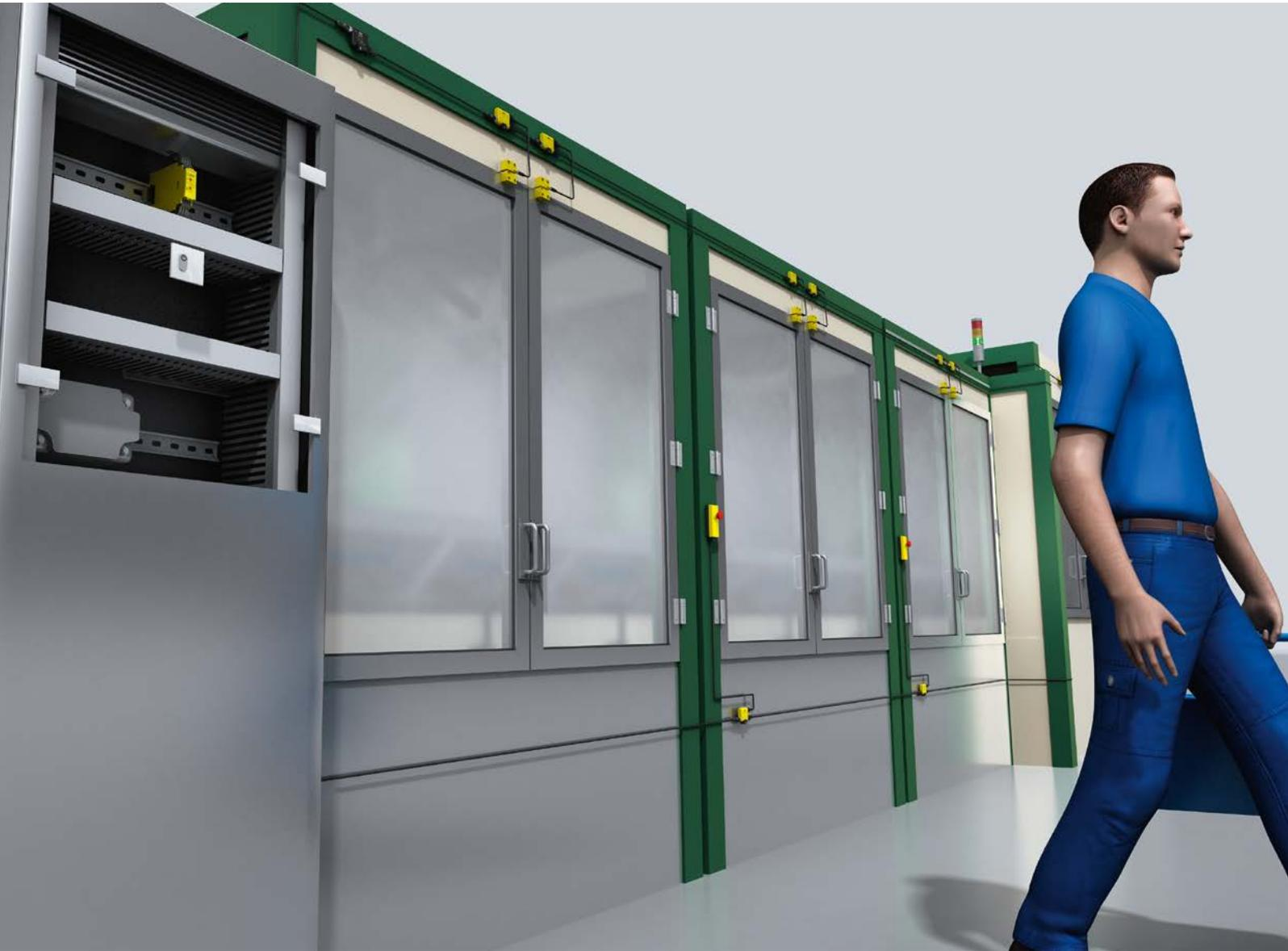
Flexi Classic 安全控制器可与 Flexi Loop 安全传感器级联共同对大型机器进行低成本智能保护。当已安装大量的门开关、紧急停止按钮、触觉防护设备和电敏防护设备, 但仅存在少数或者可能存在相当多的已扩展切断路径时, 此组合尤其发挥其潜力。通过对 Flexi Loop 级联内每个安全开关或安全传感器进行单独监控, 尽管存在安全串联, 但在考虑整体应用情况下, 性能等级不受影响。
