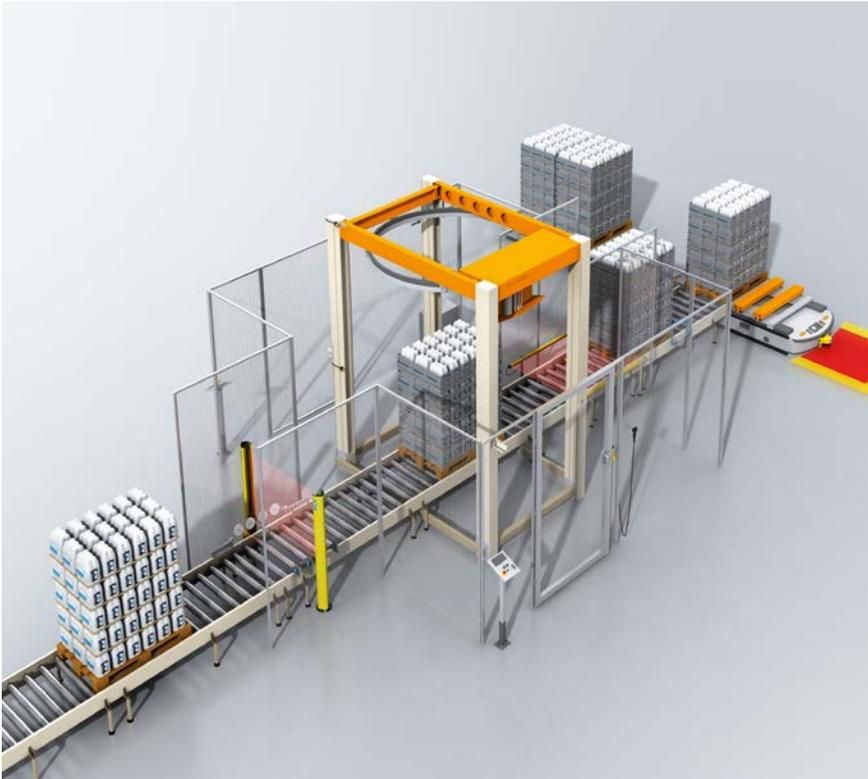
安全控制器 Flexi Classic 防止大功率机器未经授权启动。它接收已连接安全组件的所有信号,并能够在发生危险时确保将机器关断。与此同时,可通过检修门随时进行维修及保养作业。
